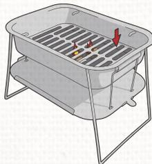
**Étape 6:** insérer un paquet de charbon en sachet, **attendre jusqu'à ce que le charbon soit complètement transformé en** braise et recouvert avec une couche de cendre. Lors de l'utilisation de charbon traditionnel, ne pas dépasser **la capacité max de 160 grammes.**
