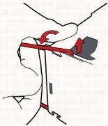
Die drei Grillfüsse ausklappen, **über** die seitlichen Einkerbungen anheben und **einhängen**.
